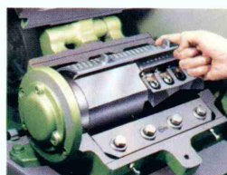
スクリーン交換はワンタッチ 'One touch' replacement of screen
